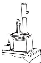
Premere il tasto **START/STOP** per far partire la titolazione. Il display mostra “- - -” durante la titolazione insieme ai riferimenti dell'agitazione e della pompa che lampeggiano e il valore del pH 7.00 o 8.20 sarà visibile sul display secondario.
