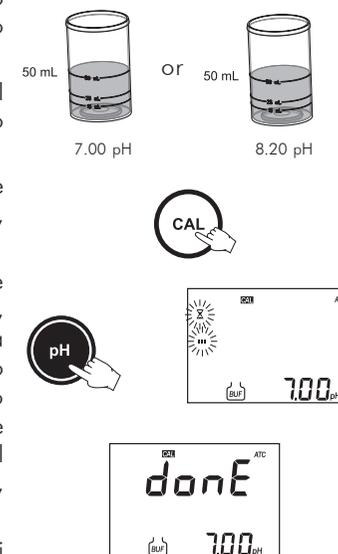
Alla fine della calibrazione, comparirà solo per alcuni secondi la scritta "DONE" prima che lo strumento torni nel modo misurazione.
