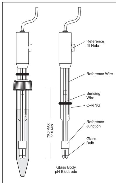
Se la soluzione di riempimento dell'elettrodo (soluzione elettrolitica) è ad livello inferiore di 2,5 cm dal foro di riempimento, aggiungere attraverso tale foro della soluzione fresca MA9011 (3.5M KCl). Per avere una risposta più veloce dall'elettrodo, allentare la vite dal foro di riempimento durante la misurazione.
