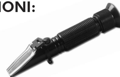
Il modello Milwaukee MR635ATC è indicato per la misurazione della concentrazione di acqua nelle lenti a contatto.
